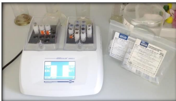
Rysunek 7. Proces mineralizacji prób w celu oznaczenia związków fosforu
