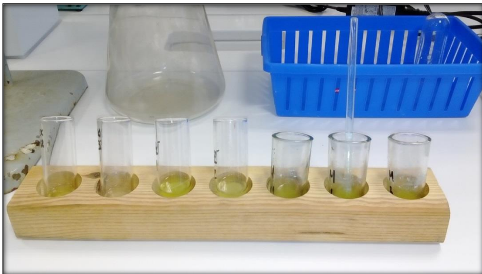
Rysunek 6. Zmaczerowane sączki w roztworze acetonu przygotowane do odwirowania
