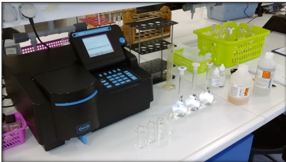
Rysunek 8. Spektrofotometryczne oznaczanie związków azotu w badanych próbach
