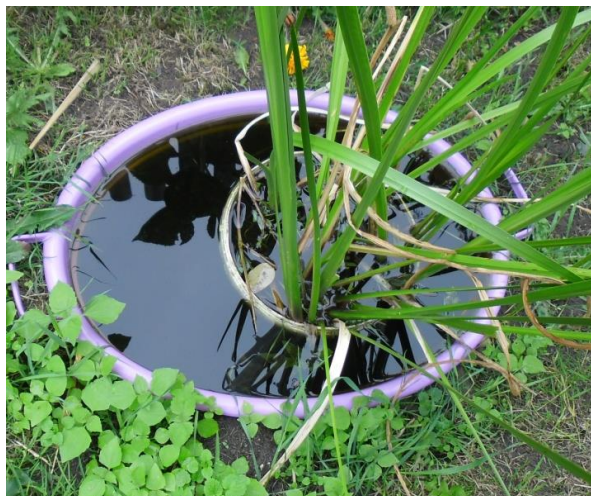
Rysunek 1. Minioocyszczalnia z tatarakiem zwyczajnym ( Acorus calamus L.), zbudowana na potrzeby badań
