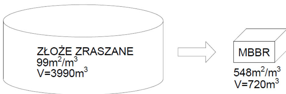
Rysunek 10. Porównanie objętości reaktora złoża zraszanego i reaktora MBBR przy tych samych parametrach dopływu i odpływu ścieków
