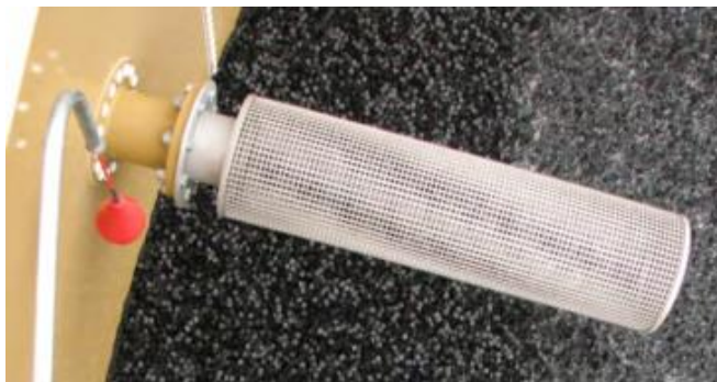
Rysunek 5. Sito cylindryczne na odpływie z reaktora MBBR
