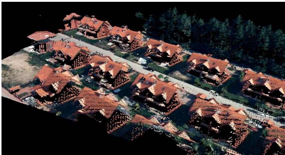
Rysunek 6. Rzut izometryczny chmury punktów LiDAR z obszaru objętego opracowaniem z nadanym atrybutem kolor RGB
