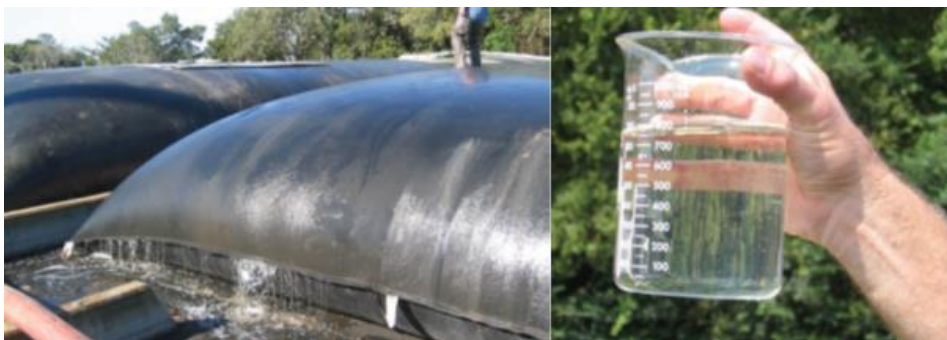
Rysunek 3. Odwadnianie osadu. Widoczny uzyskiwany czysty filtrat
