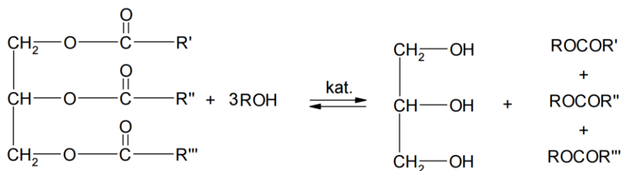
Rysunek 2. Schemat procesu transestryfikacji olejów roślinnych [zmodyfikowany]
