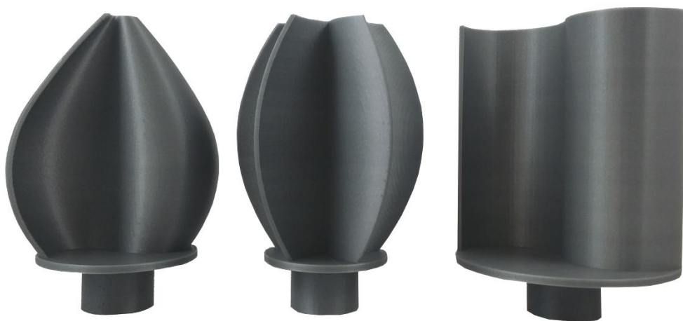
Rys. 14. Wykonane modele turbin wiatrowych (od lewej): „gruszka”, „karambola” oraz „yin-yang”
