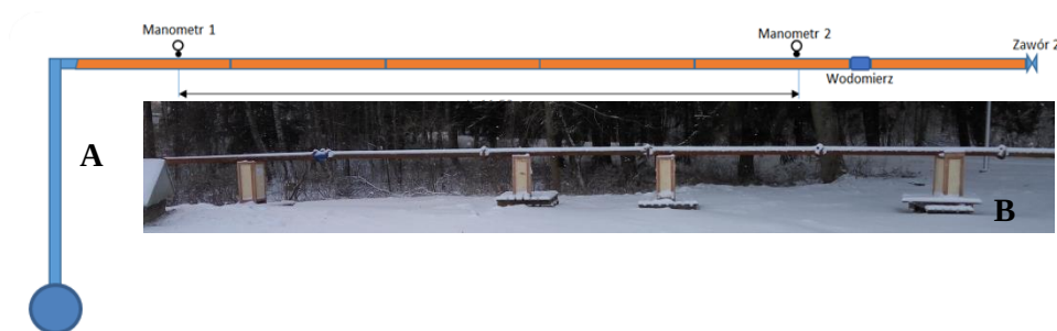
Rys. 3. Stanowisko badawcze na ujęciu Jurowce (A – schemat, B – zdjęcie stanowiska)
