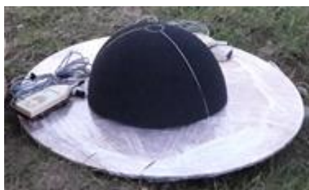
Rys. 3. Płyta z mikrofonem wykorzystana do pomiarów akustycznych
