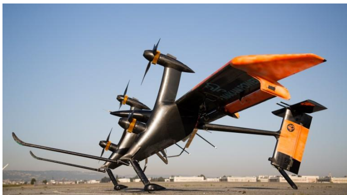
Rys. 12. Latająca turbina wiatrowa Makani Power
