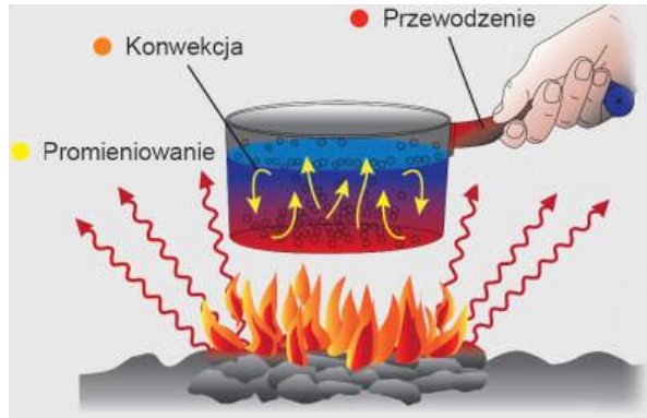
Rys. 1. Przykład trzech transferów ciepła występujących jednocześnie podczas podgrzewania wody
