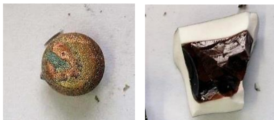
Rys. 4. Produkty przetopienia głównej frakcji zgazowania (metal + fragment fazy żużlowej)
