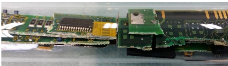
Rys. 2. Przygotowana do zgazowania karta sieciowa (fragment) Źródło: [20]
