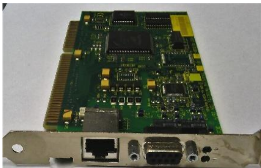
Rys. 1. Karta sieciowa (3 Com PC/AT ISA) poddana zgazowaniu w atmosferze pary wodnej Źródło: [1]
