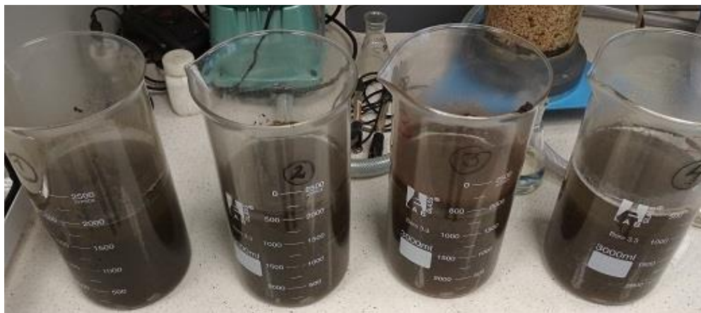
Fot. 1. Bioreaktory: 1 - ścieki komunalne, 2 - ścieki cukiernicze, 3 - ścieki z produkcji soku warzywnego, 4 - ścieki z zużytych olejów spożywczych
