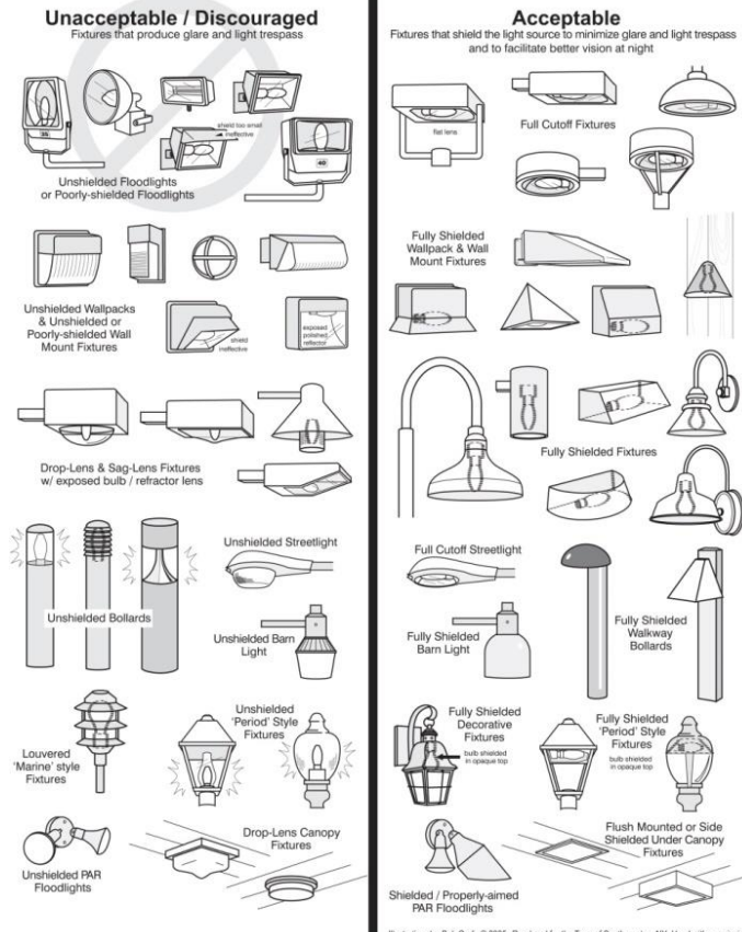
Rys. 5. Przykłady nieprawidłowego i prawidłowego oświetlenia zewnętrznego.
