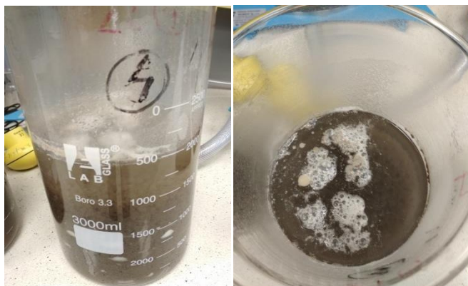
Fot. 3. Osad czynny przy wyższym obciążeniu ściekami zawierającymi zużyty olej spożywczy
