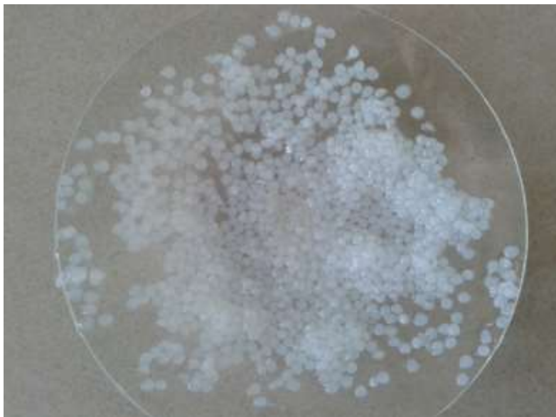
Rysunek 4. Przygotowywanie kulek chitozanowych: a) rozpuszczanie chitozanu; b) wytrącanie kulek; c) otrzymane kulki chitozanowe
