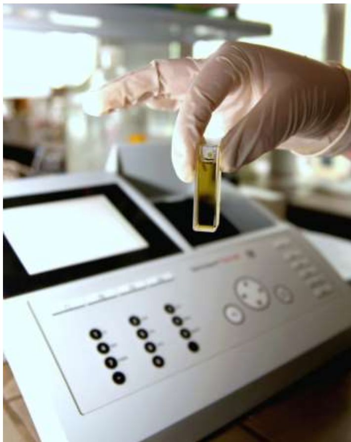
Rysunek 12. Pomiary zawartości chlorofilu „a” przy pomocy spektrofotometru Merck Spectroquant Pharo 300
