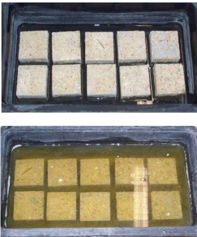
Rysunek 10. Próbki kompozytów cementowych podczas badania nasiąkliwości
