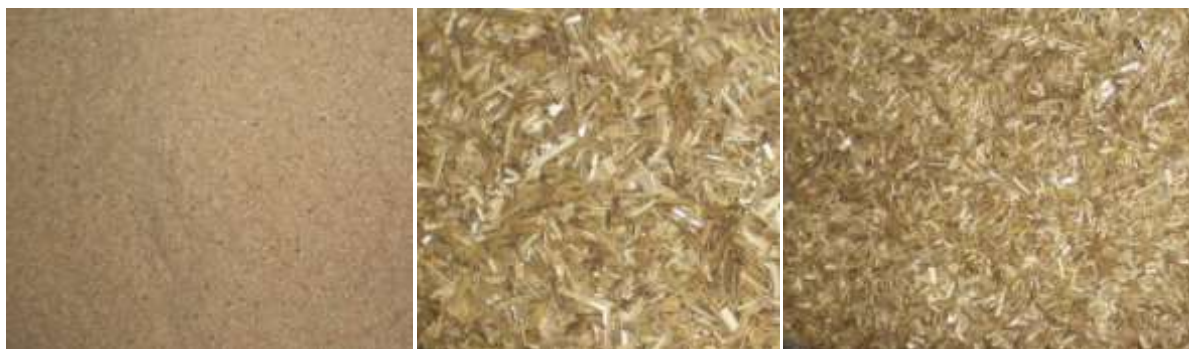
Rysunek 5. Trociny i trzcina użyte do wykonania mieszanki betonowej
