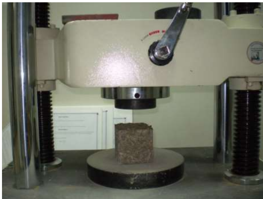
Rysunek 12. Próbkę kompozytu cementowego podczas badania wytrzymałości na ściskanie
