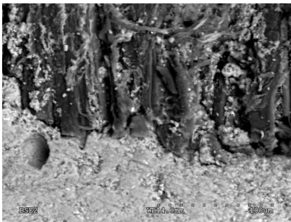
Rysunek 15. Charakter strefy kontaktowej pomiędzy rozwiniętą powierzchnią trzciny a zaprawą cementową (powiększenie 500x)
