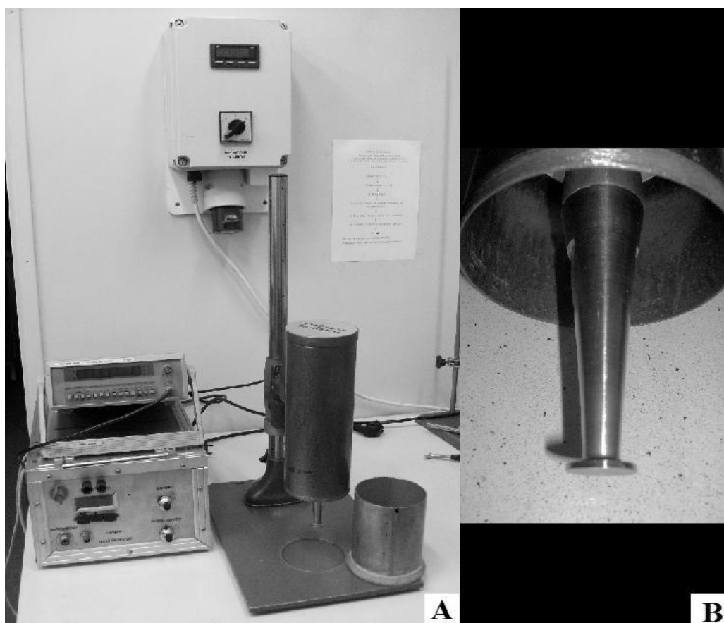
Rysunek 4. Dezintegrator WK - 2000 (A); głowica z wydłużonym koncentratorem energii (B)
