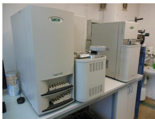
Rysunek 5. Analizator rtęci AMA 254 (z lewej) oraz układ pieców układu TruSpec CHNS (z prawej)
