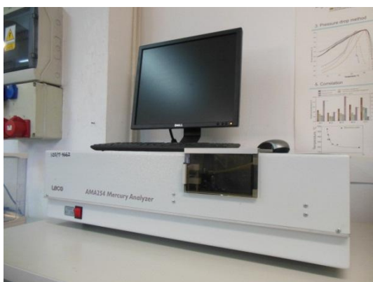
Rysunek 5. Analizator rtęci AMA 254 (z lewej) oraz układ pieców układu TruSpec CHNS (z prawej)
