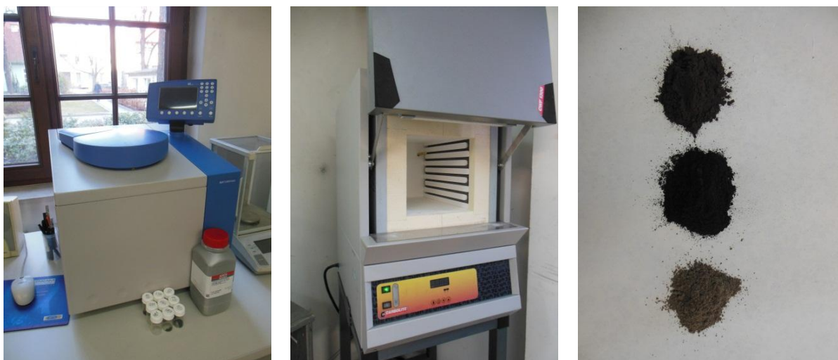
Rysunek 6. Do lewej: kalorymetr IKA C2000, piec muflowy oraz przykładowe próbki
