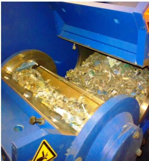
Rysunek 3. Paliwo zaklejone tuż przed nożami tnącymi
