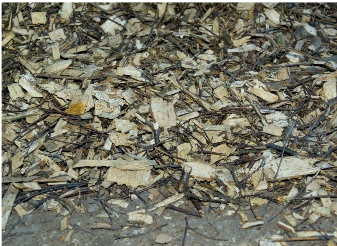
Rysunek 13. Zrębki drzewne – paliwo spalane w piecach ciepłowni
