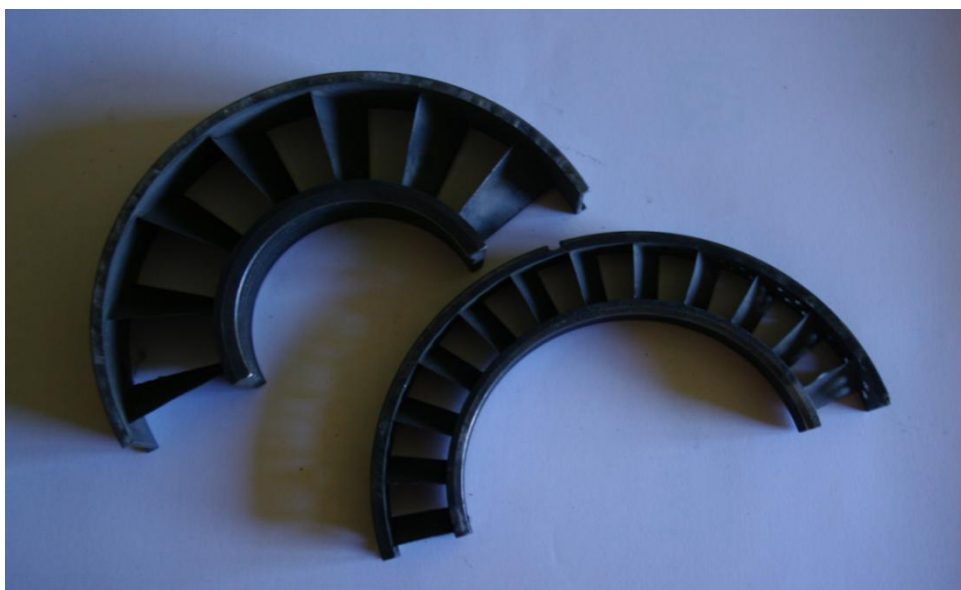
Rysunek 10. Tarcze kierownicze sprężarki silnika GTD-350
