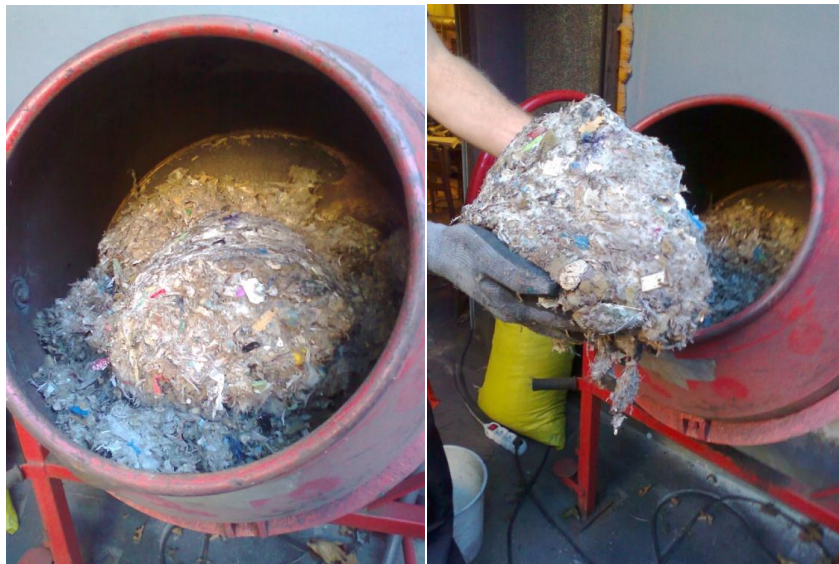
Rysunek 1. Bryły paliwa powstałe podczas składowania
