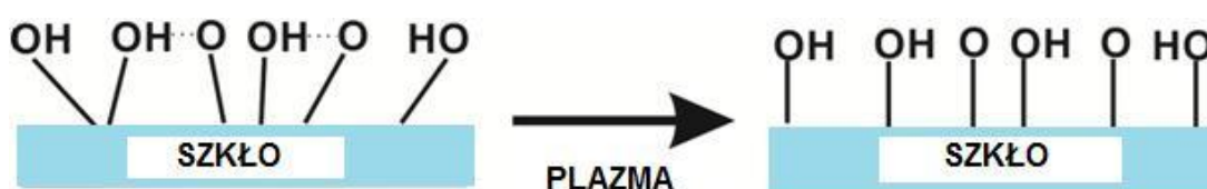
Rysunek 11. Aktywacja powierzchni szkła przy wykorzystaniu techniki plazmowej
