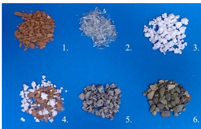
Rysunek 11. Składniki kruszywa grubego w badanych próbkach betonowych. Zanieczyszczenia: cegła 1, szkło 2, styropian 3, mieszanka zanieczyszczeń 4, kruszywo wtórne 5, kruszywo naturalne 6.
