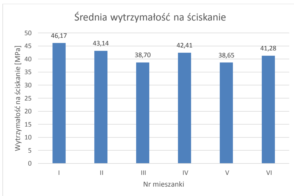
Rysunek 15. Średnia wytrzymałość na ściskanie próbek referencyjnych oraz zawierających zanieczyszczenia
